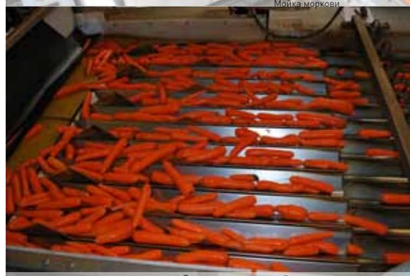
Транспортер оптической сортировки
